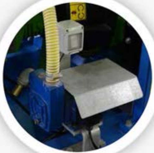
مضخة تعمل بالتحضير الكهربائي محرك ٢٤-١٢ فولت متصلة ببطارية المحرك مضخة كهربائية ذاتية التحضير
